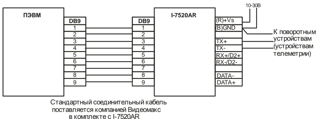
**Рис. 16 Типовая схема подключения преобразователей интерфейса I-7520AR**
