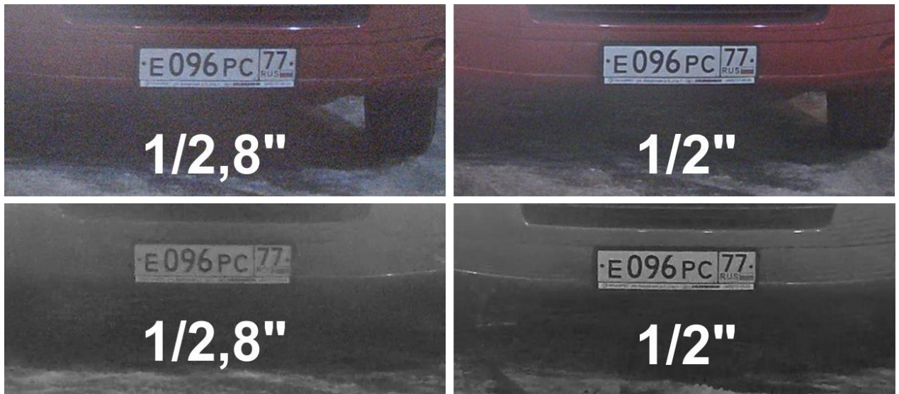
Рис. 2 Разница изображения номера на камерах с матрицами 1/2,8" и 1/2"
