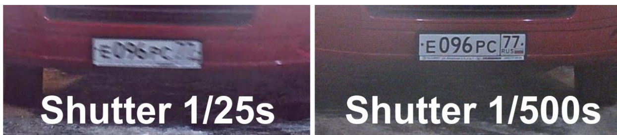
Рис. 3 Разница изображений движущегося автомобиля с различными параметрами выдержки
