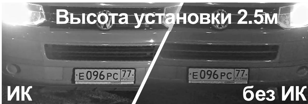
Рис. 6 Использование ИК подсветки для распознавания номеров
