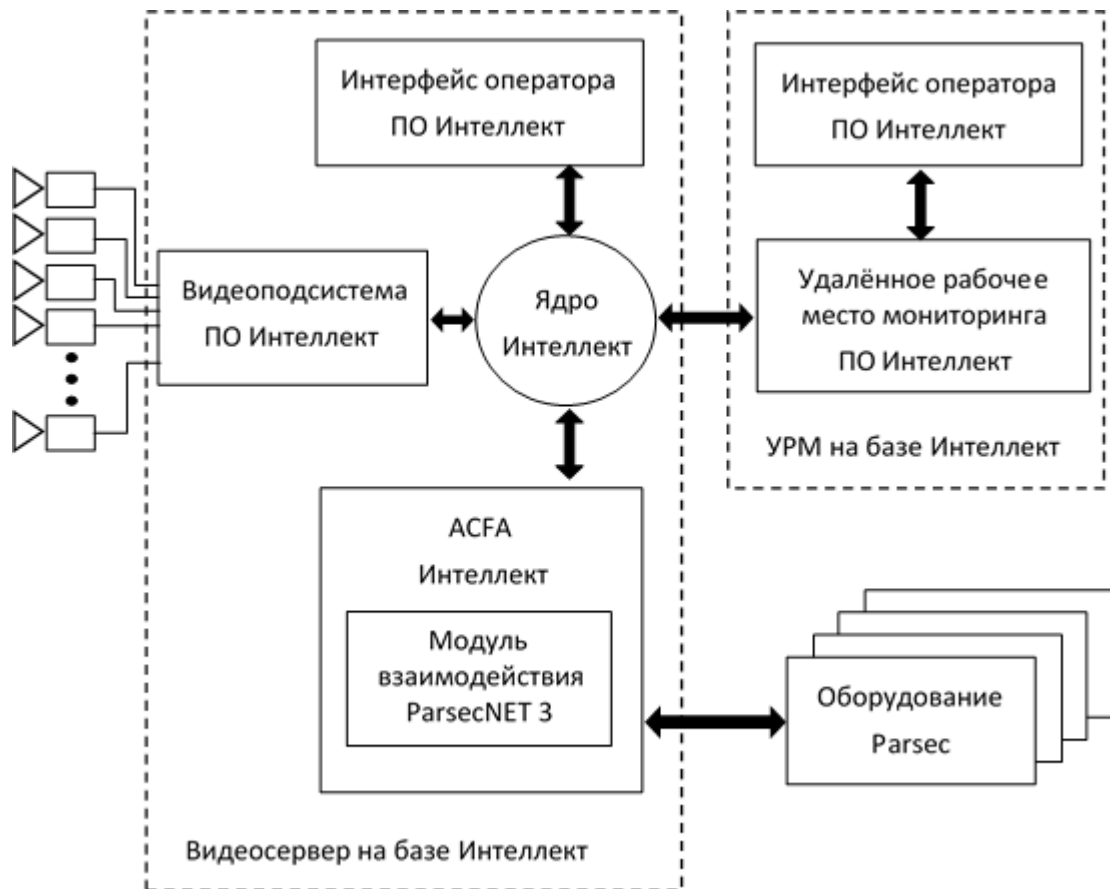
Рис. 1 Схема интеграции ПО Интеллект с контроллерами Parsec на уровне ядра ПО Интеллект
